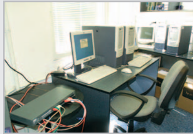
CZTERY LUB OSIEM KOMPUTERÓW podłączonych do testowanego urządzenia symulowało rzeczywistą pracę w sieci.
